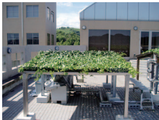
写真1-1 屋上緑化システム試験装置
