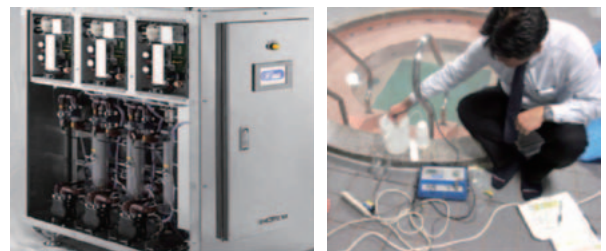
写真2 大型業務用水素水生成装置（モニター機）の概観（左）と水素風呂の溶存水素濃度計測の様子（右）
